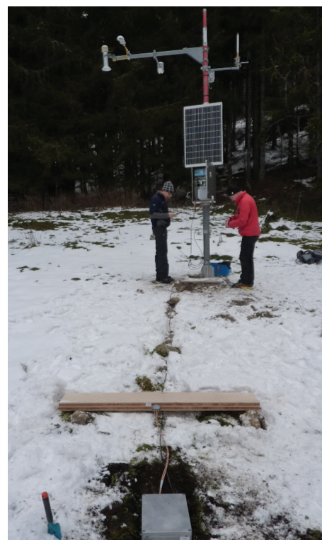
Slika 4: Radar snežne odeje med namestitvijo. (Veitsch)
